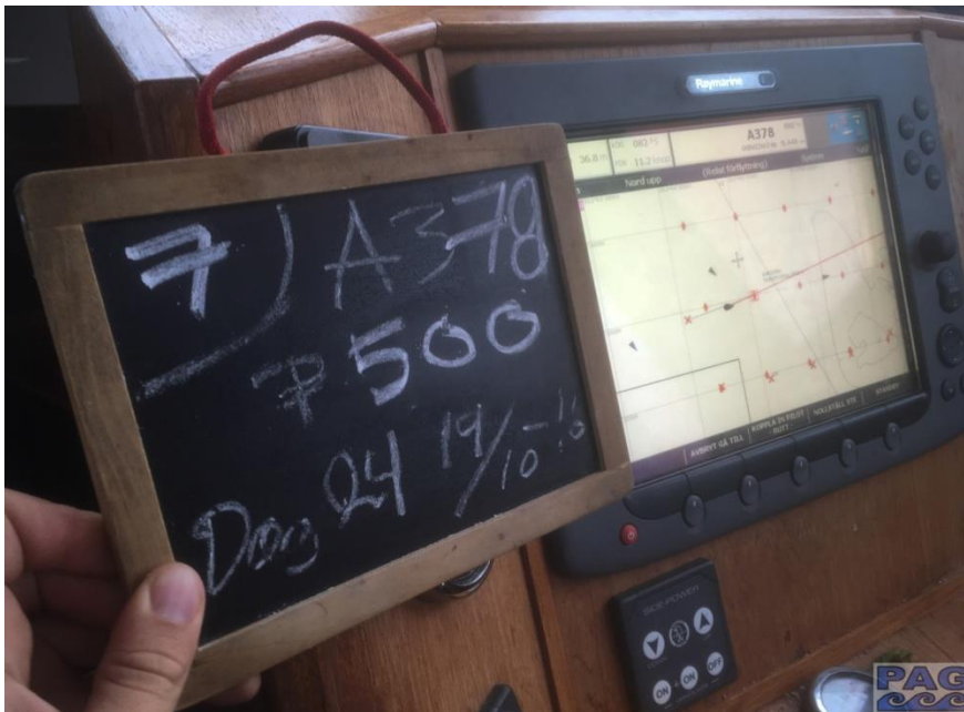
Stationsnummer och löpnummer stäms av mot navigationsplotter inför start av en ny videoprovtagning.
